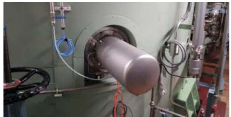
Figure 2. Crystobserver® ถูกติดตั้งแทนที่กล้องแบบอนาล็อก ณ โรงงาน ในกลุ่ม Hokuren ประเทศญี่ปุ่น จำนวน 4 ตัว
